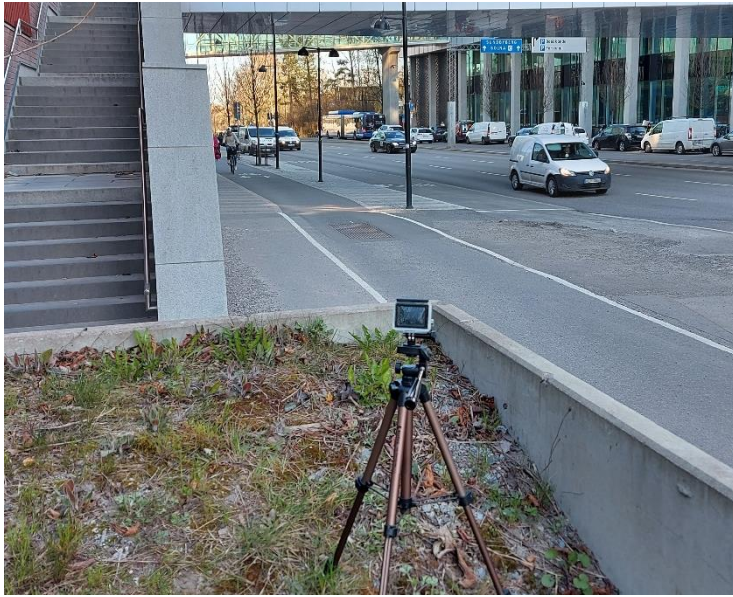
Figur 30. Placering av kamera för att ej störa trafiken vid studieplats Karolinska.
